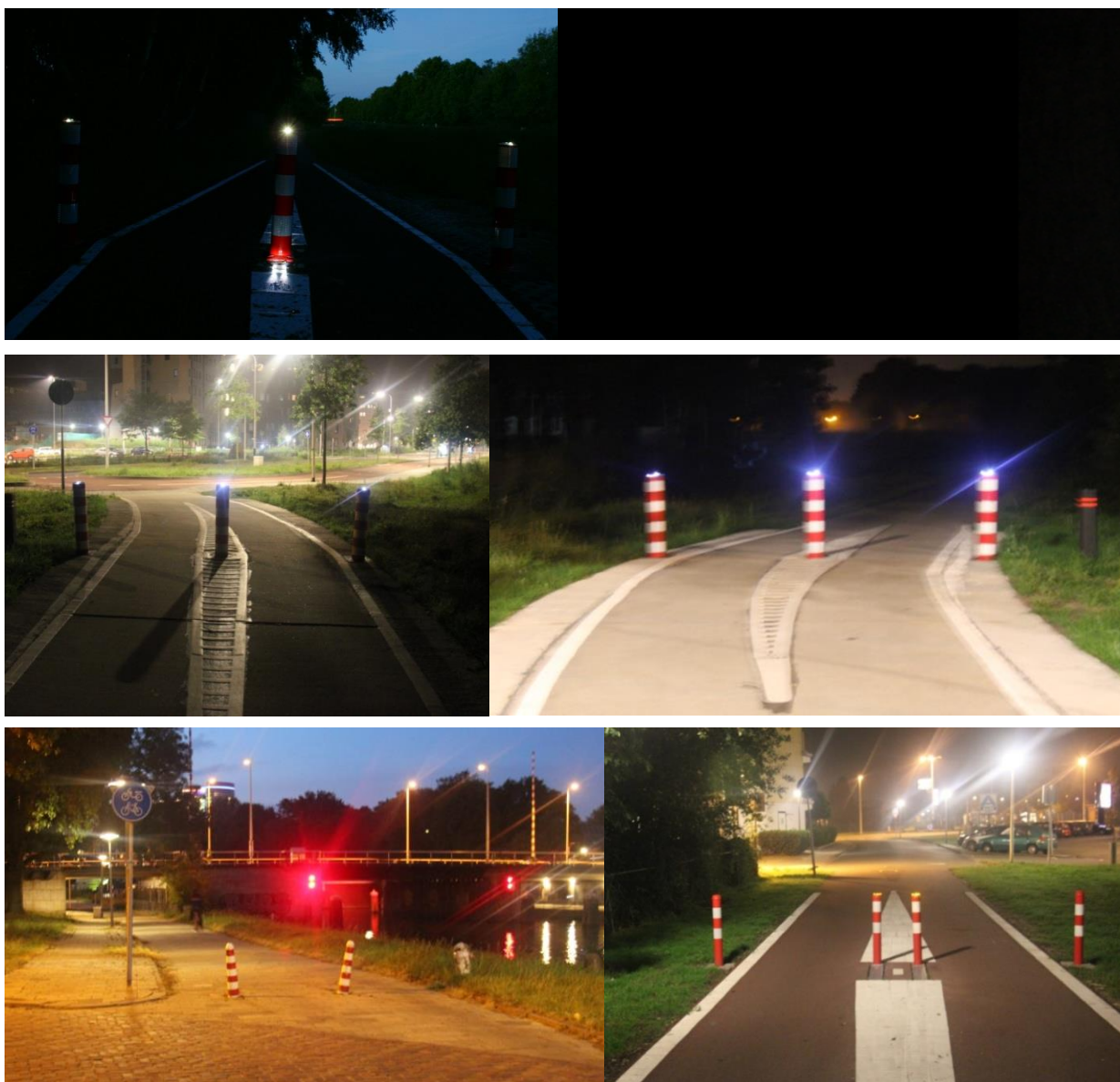
Figuur 10: Impressie zichtbaarheid palen bij duisternis. Boven: Hardenberg (links) met LED's die o.a. de paal aanschijnen en Bunnik (rechts) zonder enige vorm van verlichting. Midden: Zwolle met de blik naar het kruispunt (links, verstorend effect van openbare verlichting op de achtergrond) en Zwolle met de rug naar het kruispunt (rechts). Onder: Controle-locatie Utrecht (links, verstorend effect bruglicht op achtergrond) en Enschede (recht, met knipperende gele LED's).
