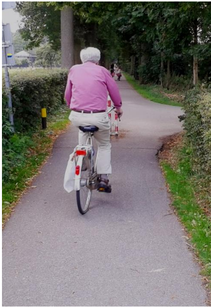
Figuur 5: Links slecht voorbeeld van paal op smal fietspad. Doorgang is te smal, vlak voor kruispunt en markering ontbreekt. Rechts proeflocatie in Hardenberg. Fietspad is ter hoogte van palen verbreed tot 330 cm. Fietzers benutten extra ruimte om meer afstand te houden tot palen.
